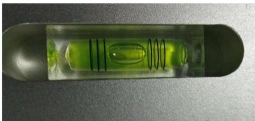
在涂布机的两端都配有小型水平仪，确定好摆放位置后，调节涂布机的四个地脚，已达到水平位置即可
