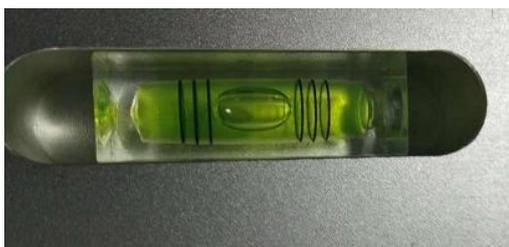
在涂布机的两端都配有小型水平仪，确定好摆放位置后，调节涂布机的四个地脚，已达到水平
