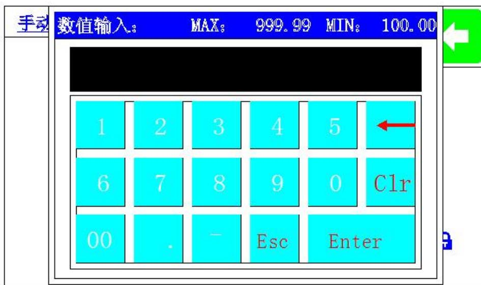
(1)在手动画面中点击速度按钮，进入当前画面。输入速度值，按 Enter 键输入或 Esc 键退出，涂布速度可以根据客户需求进行更改设定。
